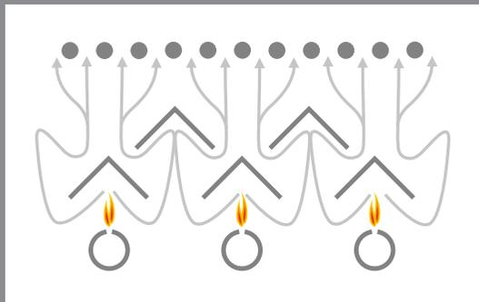
Die leicht ansteigenden Hitzeverteiler transportieren die im hinteren Bereich naturgemäß heißere Luft nach vorne und gleichen so die Temperaturdifferenz aus.
